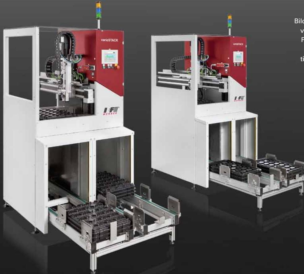
Bild 1: Die Palettiersysteme vom Typ varioSTACK mit Frontlader. Diese können von vorn mit den palettierten Rohteilen beladen werden.
