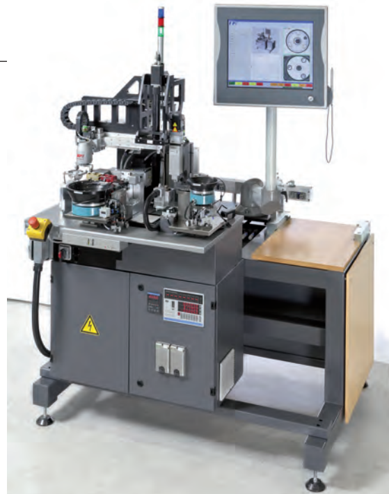
Die Fertigungszelle beruht auf dem sF-420-Design. Damit kann sie flexibel an jede Änderung in der Produktion angepasst werden
